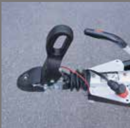
Sicherheitskupplung mit Spurstabilisierung
